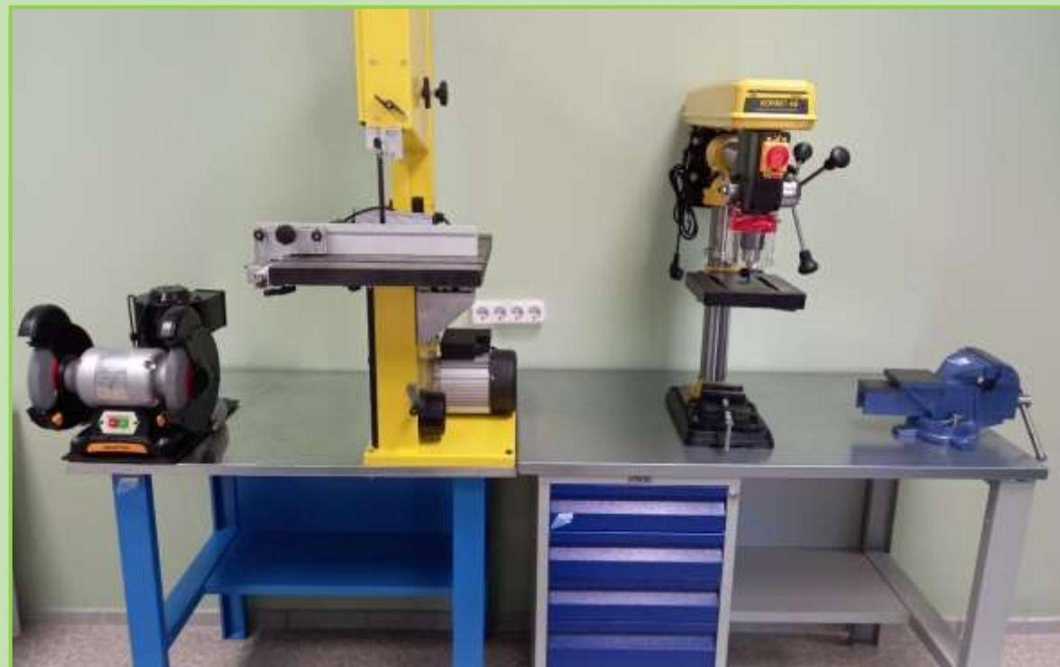
Заточной станок, ленточная пила, сверлильный станок
