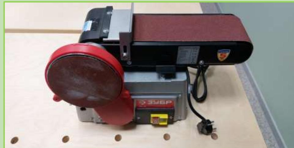
Тарельчато-ленточный шлифовальный станок
